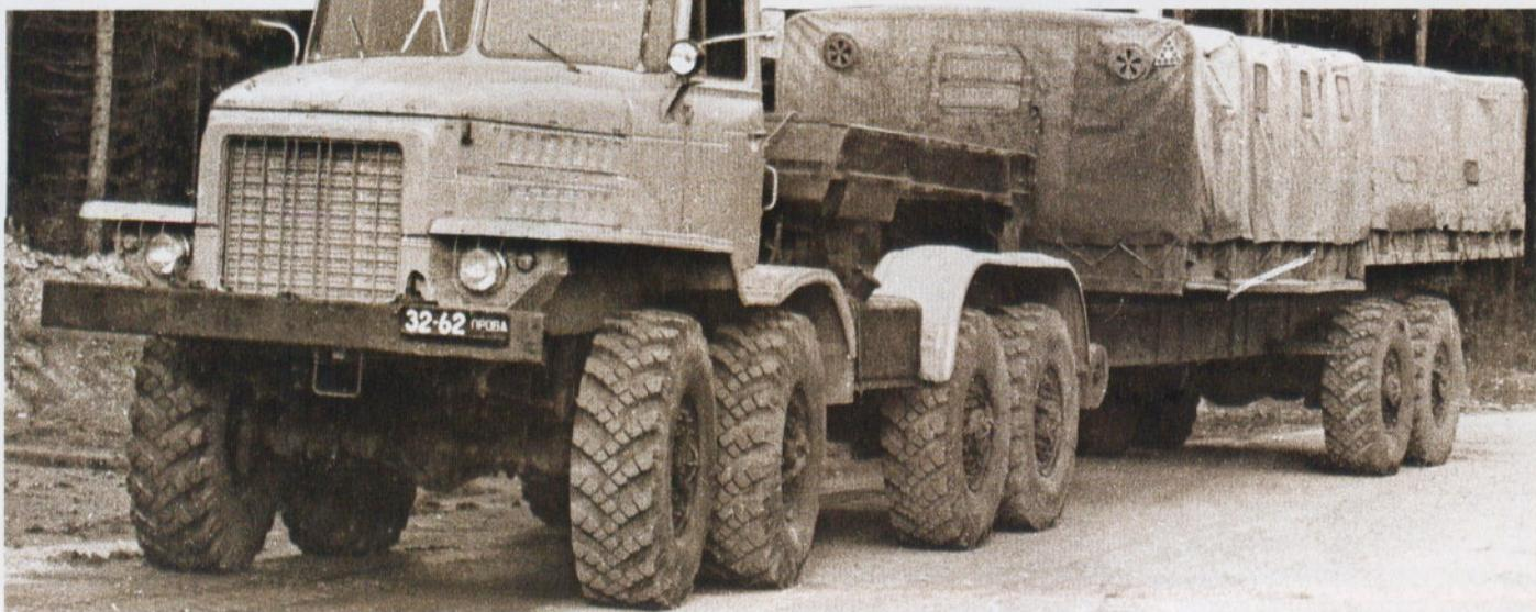
В 1965–1966 гг. в Центральном ордена Трудового Красного Знамени научно-исследовательском автомобильном и автомоторном институте НАМИ создан экспериментальный 4-осный автомобиль НАМИ-058 грузоподъёмностью 8 т. Работа проводилась на основании совместного решения Государственного комитета автотракторного и сельскохозяйственного машиностроения при Госплане СССР и в/ч 52694 от 24 июня 1965 года.
