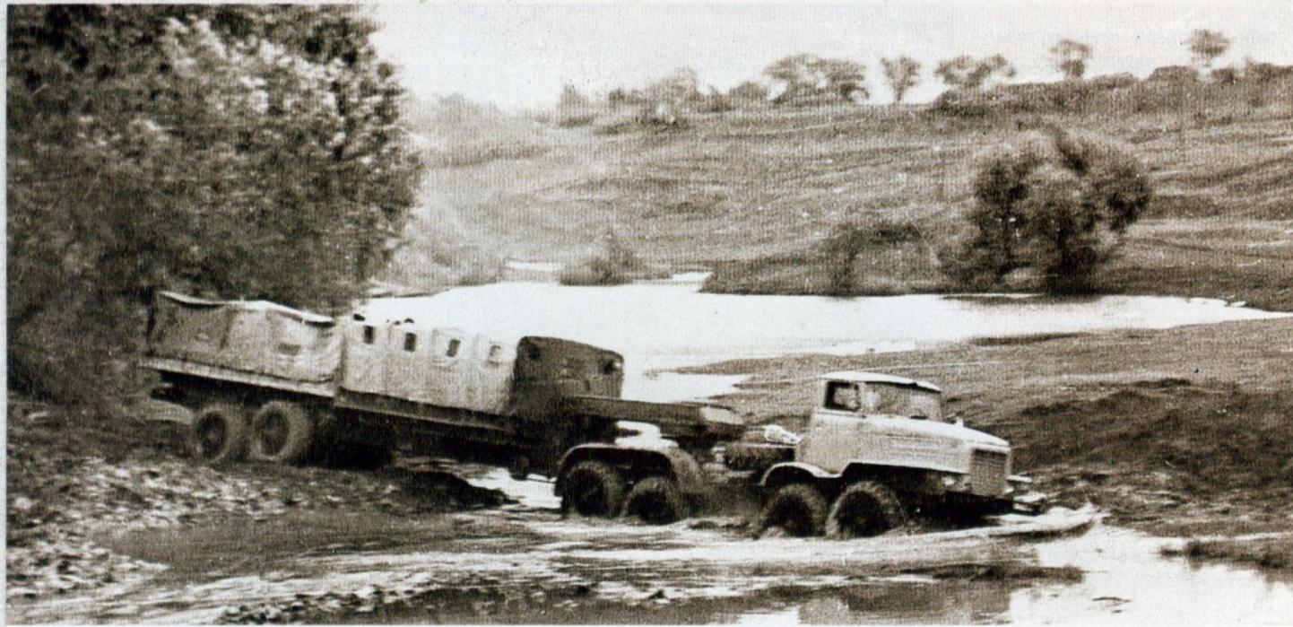
давления в шинах использовали от серийного «Урал-375», но для повышения проходимости на мягких грунтах, песке и снегу предусмотрили возможность установки широкопрофильных шин автомобиля КрАЗ-255Б.
