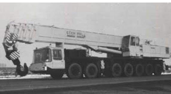
Кран КС-8471 грузоподъемностью 100 т на спецшасси ПС-1002
