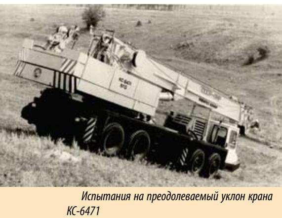
Испытания на преодолеваемый уклон крана КС-6471
