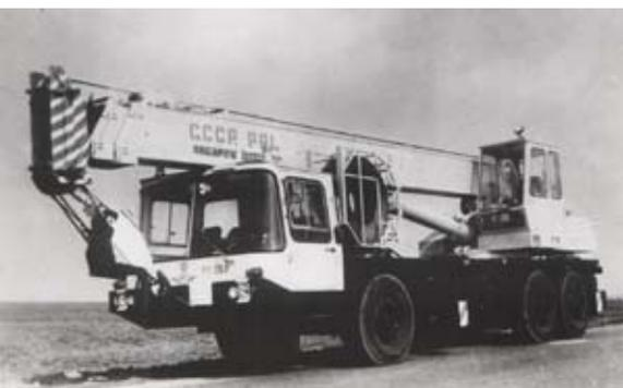
Кран КС-5473 грузоподъемностью 25 т на спецшасси ПС-253
