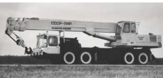
Кран КС-6471 грузоподъемностью 40 т на спецшасси ПС-401
