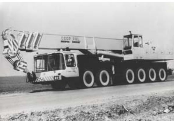
Кран КС-7471 грузоподъемностью 63 т на спецшасси ПС-632
