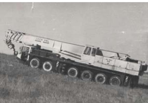
Испытания на преодолеваемый уклон крана КС-7471
