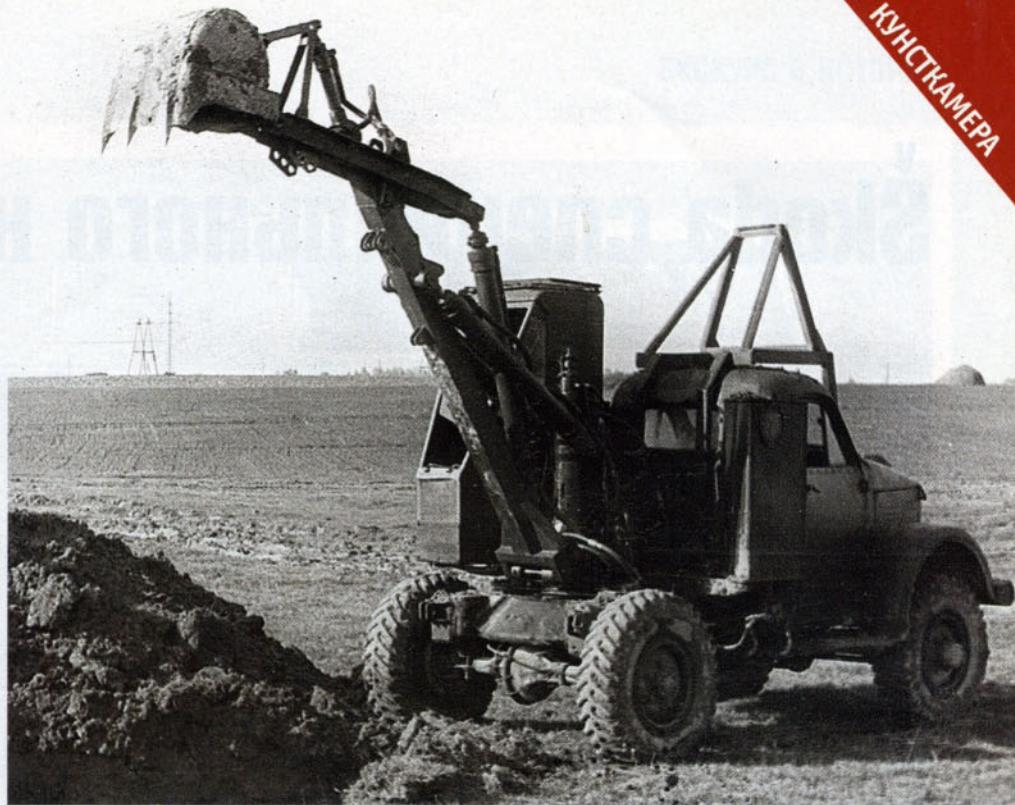
мой. Габаритные размеры: продольная база хода – 2800 мм, высота – 3430 мм, ширина – 2000 м. Вес – 4900 кг. Транспортная скорость – 50 км/ч.
